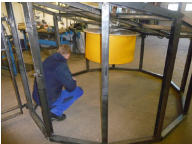
Figur 3. 2. prototypes "skelet", inden beklædning. Hulen midt i hytten kan sænkes i flere positioner.
