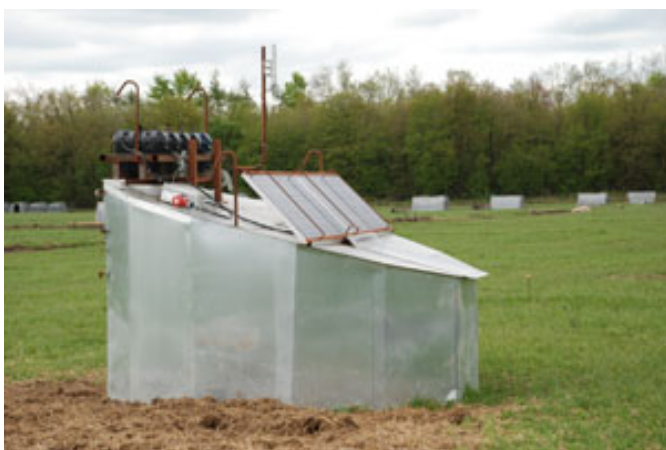
Figur 4. 2. prototype – med solcelle-drevet videoovervågning. Den kombinerede ventilations- og flugtleem er placeret i hyttens "laveste ende", og er lukket i på fotoet.
